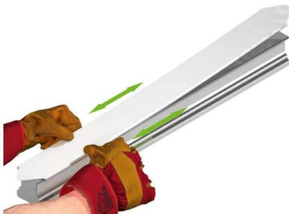
5.27. ábra: A borítószalag felszerelése
