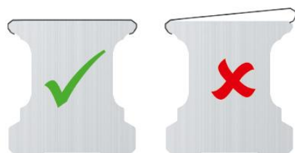
5.45. ábra: Helyesen és helytelenül felszerelt borítószalag
